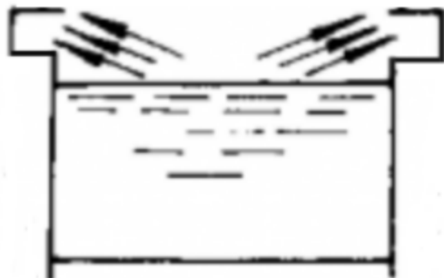
图 4.6-1 酸雾槽槽边条缝罩收集措施示意图
