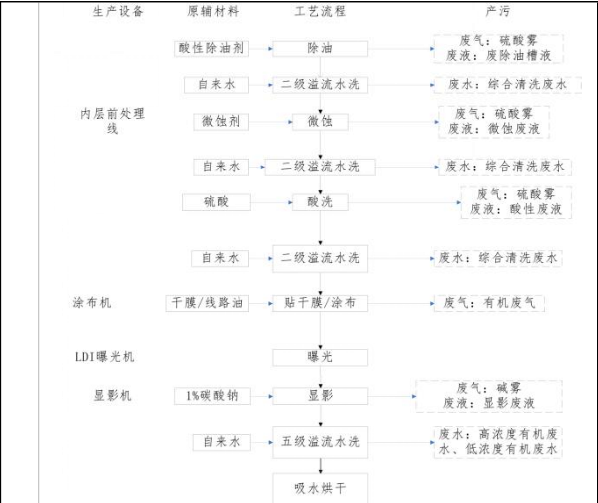
图 2-6 内层图转移工艺流程图
