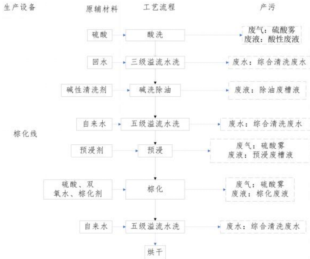
图 2-8 棕化工艺流程图
