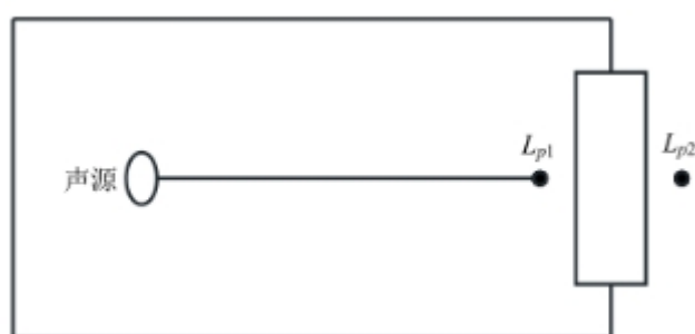
图 5.2.4-1 室内声源等效为室外声源图例
